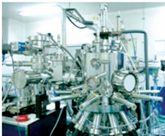
图 5(a) 从美国 SVT 公司引进的 MBE 装置, 用于 III 族氮化物半导体及其低维量子结构的外延生长。Figure 5(a) MBE equipment, made by SVT Co. in USA, for the growth of III-nitride films and quantum structures
