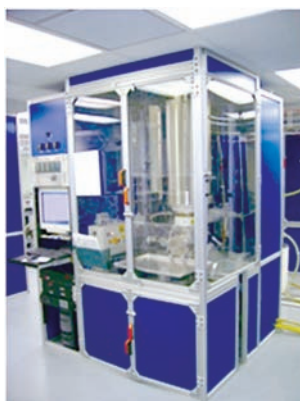
图 5(a) 从美国 SVT 公司引进的 MBE 装置, 用于 III 族氮化物半导体及其低维量子结构的外延生长。Figure 5(a) MBE equipment, made by SVT Co. in USA, for the growth of III-nitride films and quantum structures
